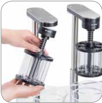
Sencillo y práctico: las cestas de prueba están acopladas magnéticamente
