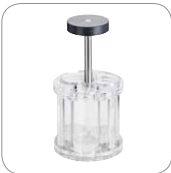
Cesta de prueba especial para comprimidos grandes
